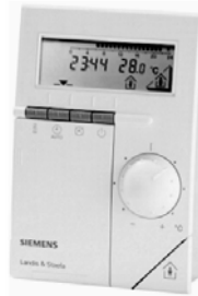
Raumgerät QAW70, mit Raumfühler, Schaltuhr, Sollwerteinstellung und Raumtemperatur-Sollwertkorrektur (Drehknopf)
